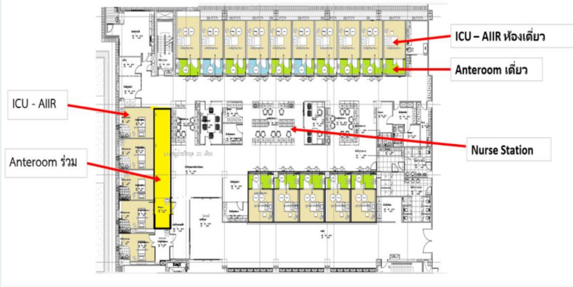
ภาพที่ 1 แบบทางกายภาพของ airborne infection isolation room (AIIR) :
